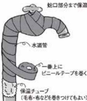
●凍ってしまったら 水道管が凍ってしまったら、自然にとけるのを待つか、凍った部分にタオルなどをかぶせて、ゆっくりとぬるま湯(20度以下)をかけてください。急に熱湯をかけると水道管や蛇口の破裂の原因になります。
