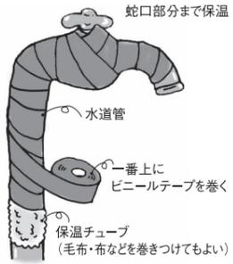
むき出しになっている水道管に、タオルや布きれなどを巻きつけるか、保温チューブなど市販の保温材を取り付けて保温してください。濡れないように、その上からビニール
