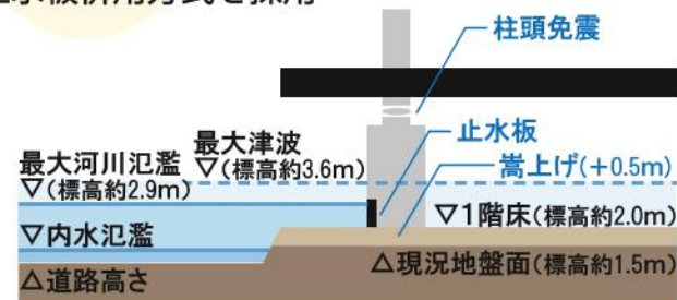
嵩上げ+止水板併用方式
