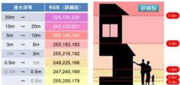
図 8-35 洪水浸水深の目安
